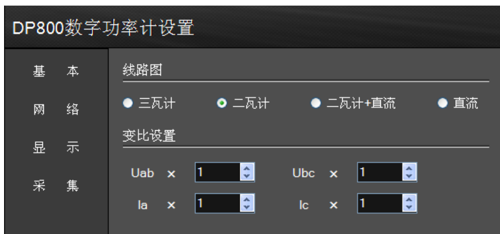
图17. DP800数字功率计软件设置界面-基本设置
