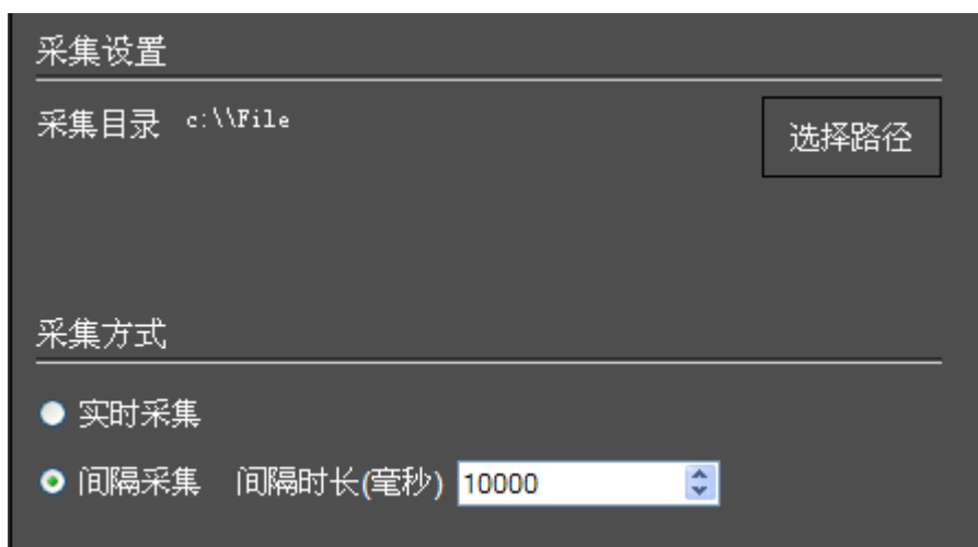
图22. DP800数字功率计软件采集设置
